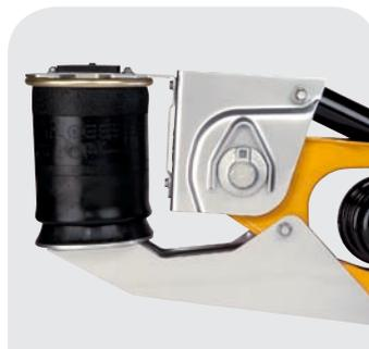
ОДНОСТОРОННИЙ МЕХАНИЗМ ПОДЪЕМА ОСИ, СПЕЦИАЛЬНО ДЛЯ МАЛОЙ ТРАНСПОРТНОЙ ВЫСОТЫ
