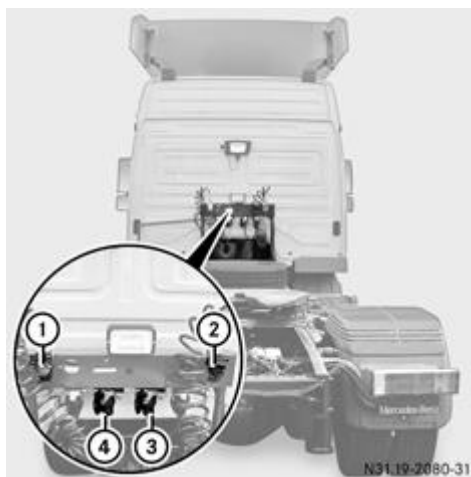
Выходы для подключения полуприцепа (пример)
