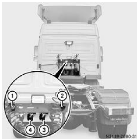
Выводы для подключения полуприцепа (пример)
