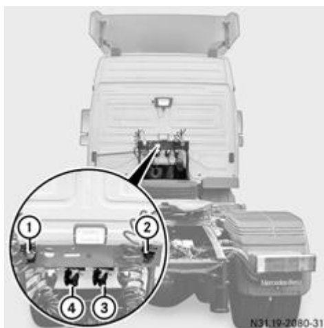
Выходы для подключения полуприцепа (пример)
